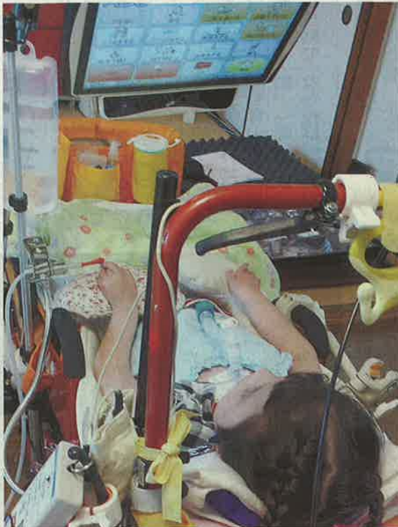
視線の方向を感知して文字や文字列を入力し、意思伝達を図る装置「マイ・トビー」を使っている女児
