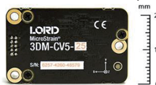
高ノイズ耐性・地磁計センサ付 小型・工業品質 姿勢方位リファレンスユニット(AHRS)
